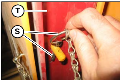
Figura 11 – Retirada del eje central de almacenamiento del soporte del brazo de elevación
