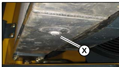
Figura 106 – Drenaje del radiador
