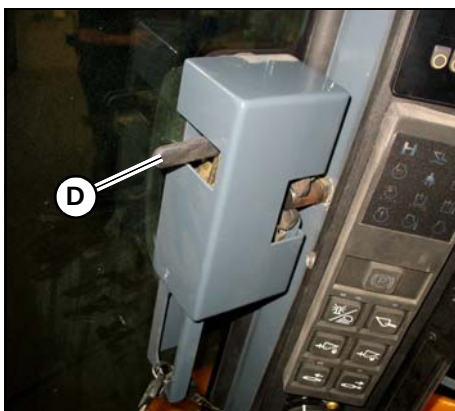
Figura 52 – Maneta interior de la puerta de la cabina
